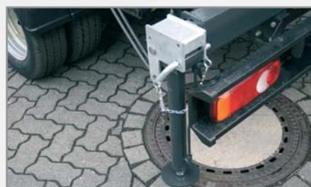
Stabilisateurs hydrauliques dans deux tubes
