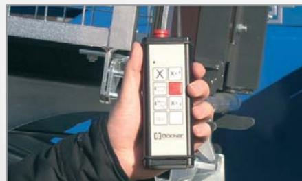
Commande électrique avec télécommande radio (en option)
